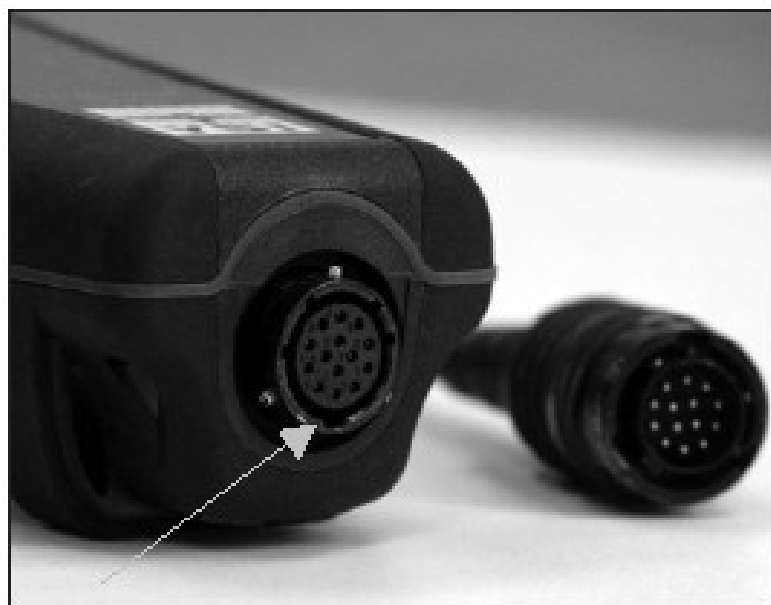
图 5. 请注意带有锁定装置的连接头。电缆和仪器的接头只有在锁定部分全部正确对应之后才能够匹配连接好。
