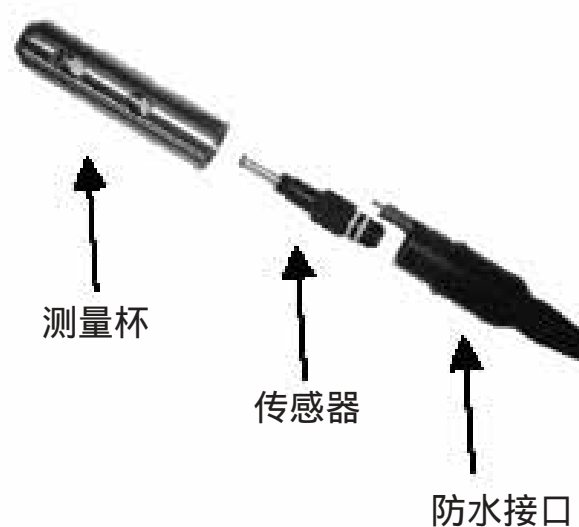
图 3. 传感器将直接安装在电缆的防水接口上。在安装后，测量杯将在采样测量时对传感器起到保护的作用（溶解氧盖膜未展示）。
